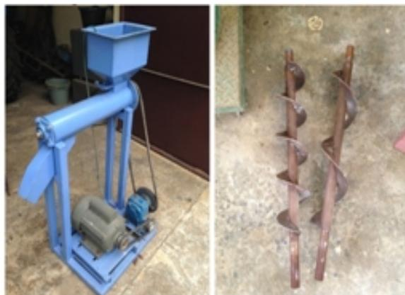
Gambar 6. Hasil rancangan a. prototipe *screw conveyor* dan b. ulir
