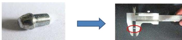
**Gambar 8.** Pengukuran Deformasi Peluru
