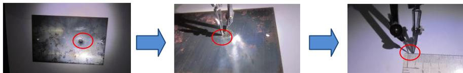
**Gambar 6.** Pengukuran keliling *crater* ketika tidak terjadi perforasi
