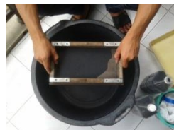
Gambar 5. Proses pengayakan dengan 100 mesh
