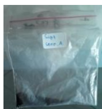
Gambar 14. Sampel sponge iron yang telah hancur menjadi butiran kecil untuk pengujian AAS
