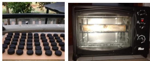
Gambar 10. Proses Pengeringan Briket
