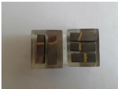
Gambar 6. Specimen pengujian baja UIC-54 Setelah di mounting .
