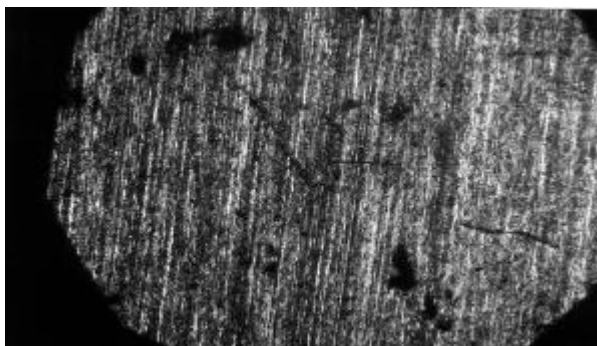
Gambar B3 Foto Makro Korosi Lubang pada Anoda Al dengan perbandingan luas A:K= 1:3 pada Salinitas 37 ‰
