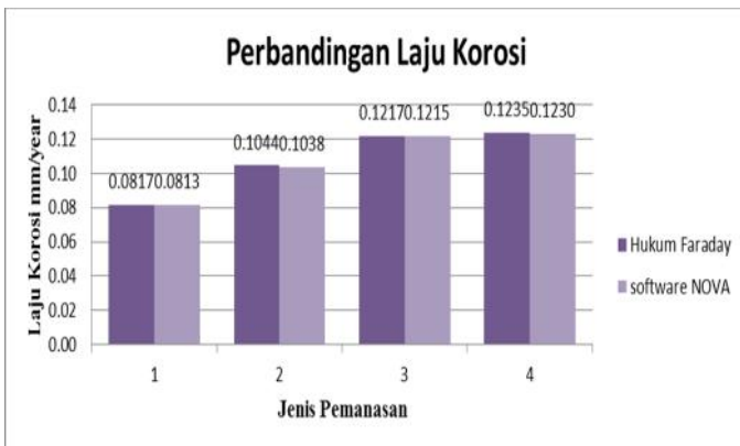
Gambar 4. Diagram Perbandingan Laju Korosi dengan Persamaan Hukum Faraday dan Software NOVA
