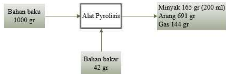
Gambar 6. Diagram Alir Pirolisis dengan Metode Counter Flow
