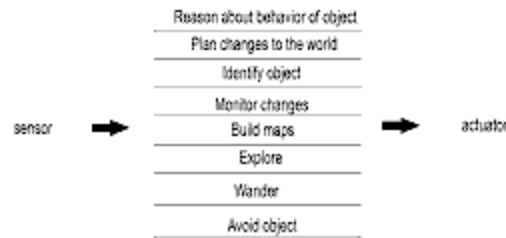
Gambar 2.3 Dekomposisi Sistem Kendali Mobile Robot dengan Task Achieving Behaviors [2]
