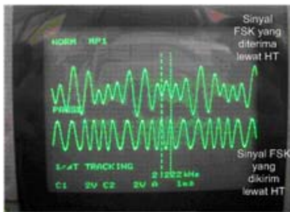
Gambar 10. Karakteristik Sinyal FSK Yang Dikirim Lewat HT
