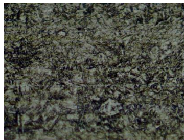
Gambar 7. Hasil uji mikro pada baja paduan 30CrMo.
