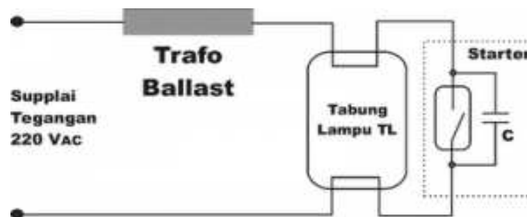
Gambar 7. Rangkaian Lampu TL Dengan Trafo Ballast [3].
