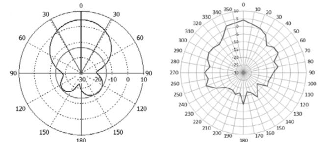
(a) Pola Radiasi hasil simulasi (b) Pola Radiasi Hasil Pengukuran
