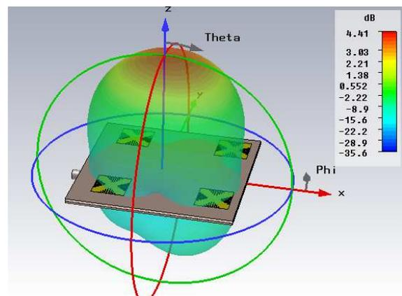
Gambar 9. Hasil simulasi pola radiasi antenna mikrostrip
