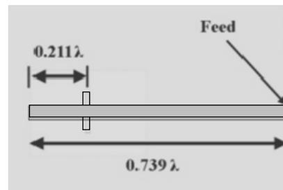
**Gambar 2.** Dimensi panjang saluran pencatu [4]
