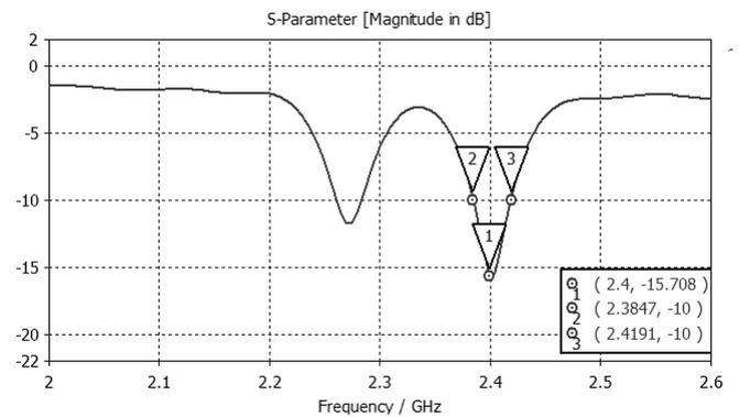
Gambar 7. Hasil simulasi *return loss* antenna mikrostrip
