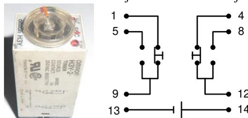
Gambar 4. TDR 24 VDC dan kontak timer 24 VDC
