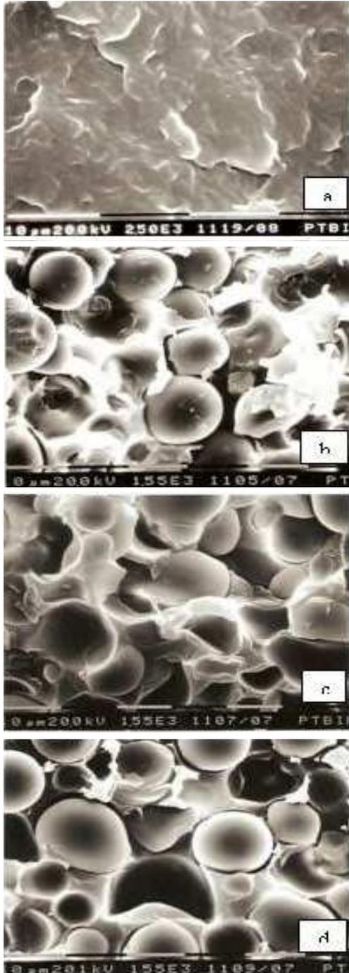
**Gambar 2.** Strukturmikro cuplikan (a). polipropilen MF10 murni dan (b), (c) dan (d) adalah polimer komposit PP10-T setelah dicampur *filler* tapioka dengan variasi komposisi masing-masing 50 %berat, 60 %berat dan 70 %berat
