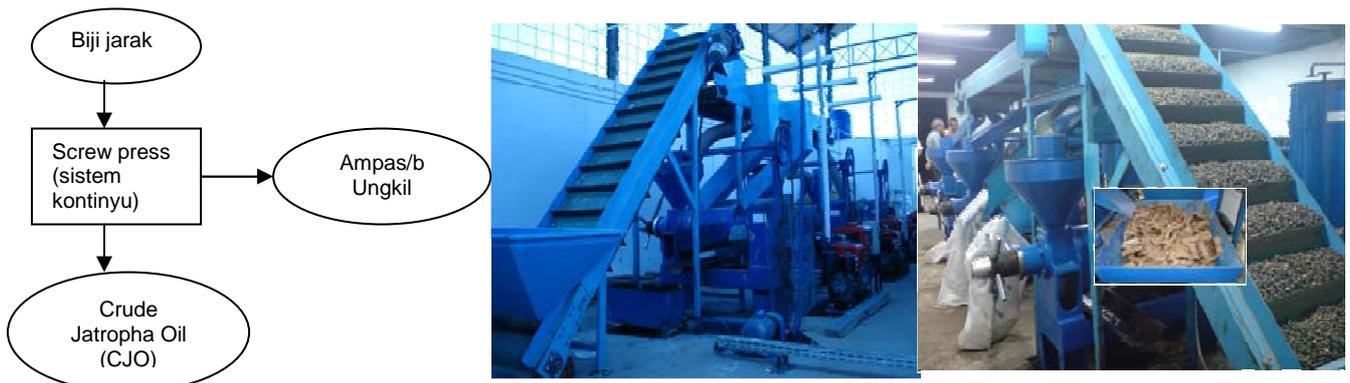
Gambar.1. Diagram alir ekstraksi minyak jarak dengan metode pengepresan berulir dan Konfigurasi unit ekstraksi minyak jarak kapasitas 300 kg/jam
