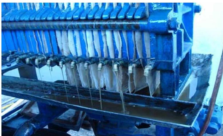
Gambar 3. proses filtrasi minyak jarak hasil degumming
