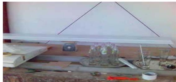
Gambar 2.4.2.4 *Horizontal Tail Plane*, (HTP) konfigurasi NA-4 ditimbang
