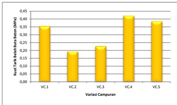
Gambar 8. Hasil Pengujian Kuat Tarik Belah dengan Variasi Campuran pada Umur 28 Hari
