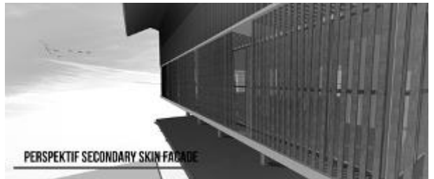
Gambar 12. Double skin façade pada bangunan galeri
