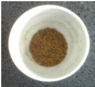
Gambar 2. Hasil kalsinasi BNT pada suhu 170 °C
