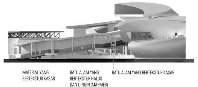
Gambar 14. Tekstur dan temperatur material pelapis dinding yang berbeda sepanjang jalur ramp (Sumber: data pribadi)
