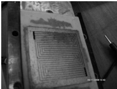
Gambar 4. Contoh terblokirnya gas bahan bakar karena air (kanan atas yang berwarna hitam lebih pekat)
