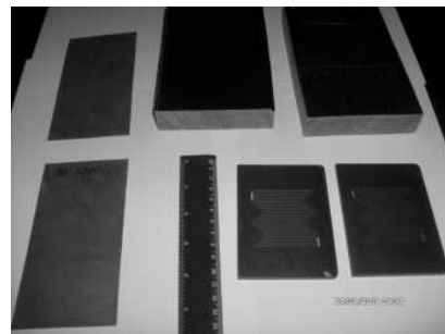
Gambar 3. Bipolar plate dengan alur gas bahan bakar jenis serpentin (kanan bawah) dan komponen fuel cell stack lainnya
