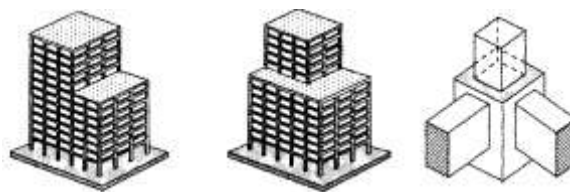
Gambar 1. Bangunan podium Sumber: Widodo 2013
