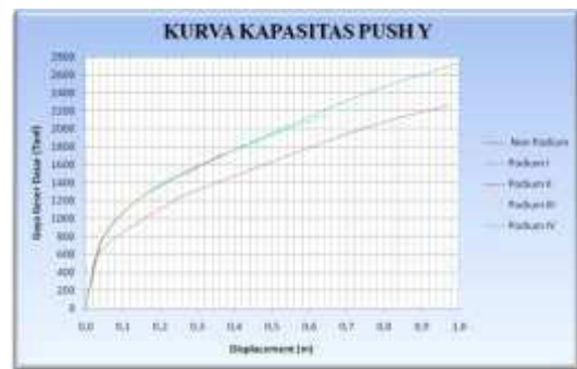
Gambar 12. Kurva Kapasitas akibat Push Y
