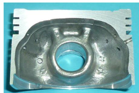
Gambar 4. Sampel piston *casting* potongan memanjang
