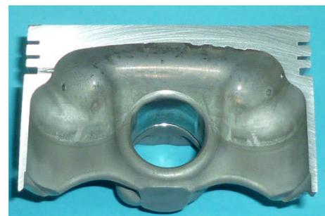
Gambar 3. Sampel piston *forging* potongan memanjang
