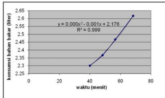
**Gambar 5 -** Hubungan Konsumsi Bahan Bakar dengan Waktu Pemanasan
