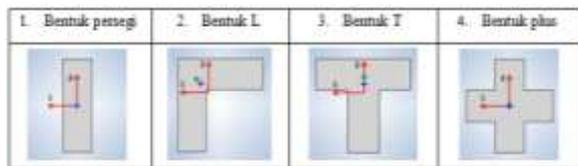
Gambar 4. Bentuk-bentuk kolom
