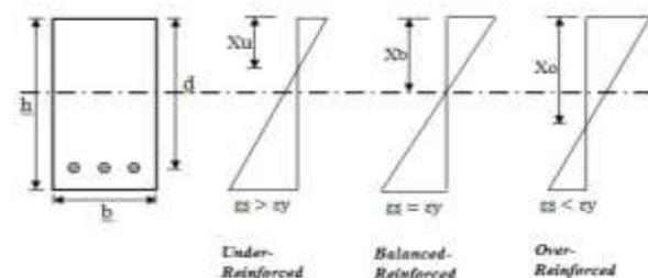
Gambar 1. Diagram regangan tipe keruntuhan penampang
