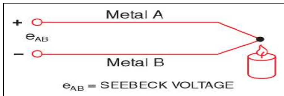
Gambar 2. Tegangan Seebeck yang Muncul Akibat Perubahan Temperatur pada Termokopel
