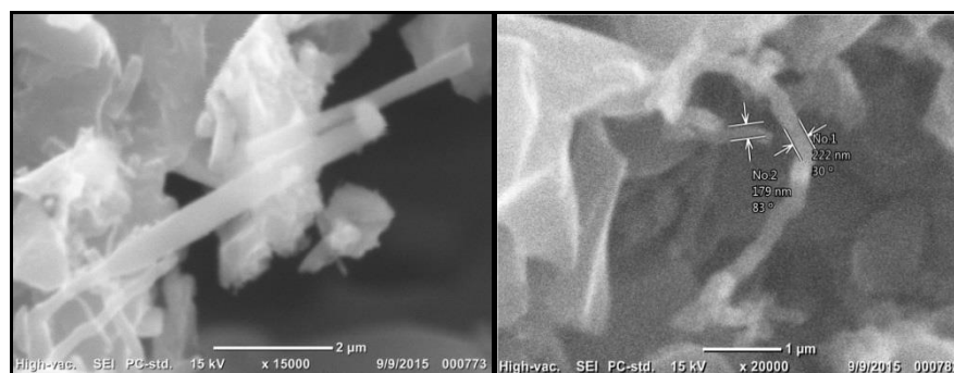
Gambar 6. Hasil Karakterisasi CNT menggunakan SEM
