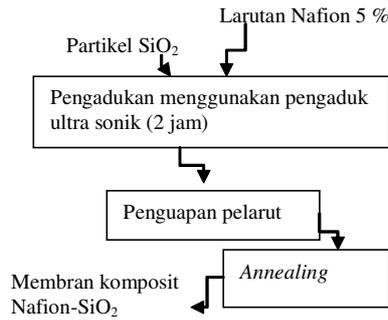
Gambar 2. Diagram alir sintesis membran komposit Nafion-SiO<sub>2</sub> metode dispersi
