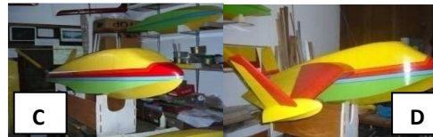
Gambar 4. Pembuatan model uji dengan variasi letak step, dengan sistem modul. Modul step (A), Modul step dan badan dirangkai (B dan C), Model uji lengkap (D).
