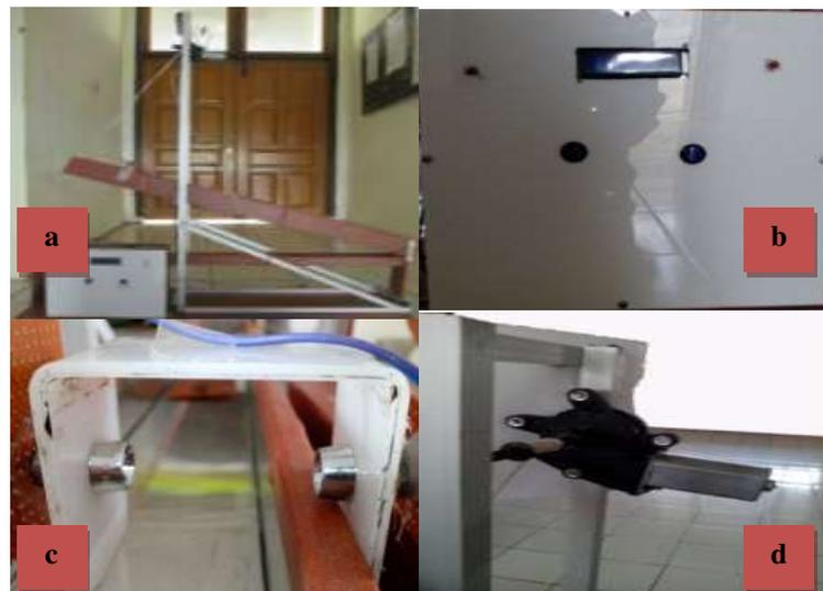
Gambar 10 Foto Hasil Rancangan Sistem: a) Set Eksperimen, b) Panel Depan, c) Sensor *Phototransistor* dan LED, d) Motor DC
