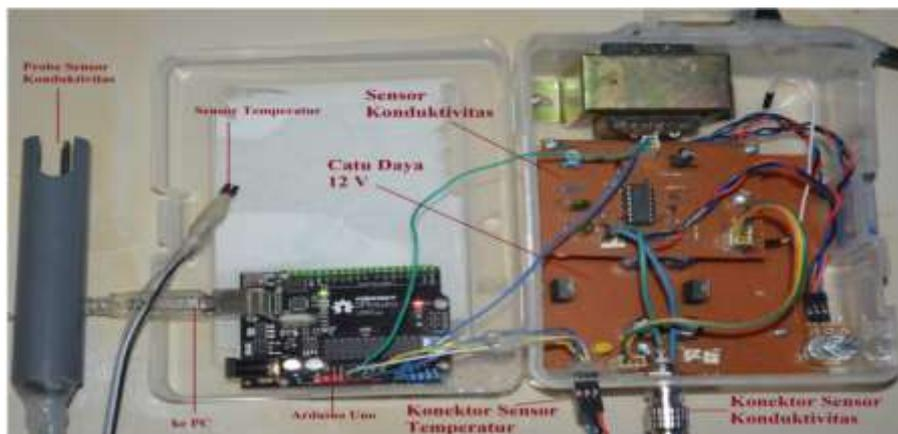
Gambar 4 Rangkaian Keseluruhan Alat Ukur TSS Air
