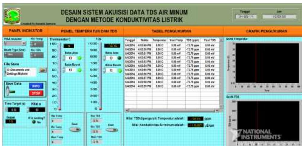
Gambar 5 Tampilan Program *LabView* untuk Pengukuran TDS Air
