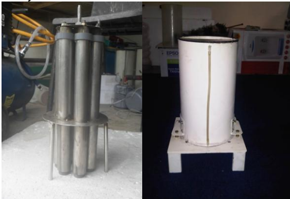
(a) anoda-katoda, (b) Tabung elektrolisa Gambar 1 (a) anoda-katoda, (b) Tabung elektrolisa
