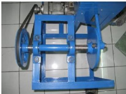
Gambar 4. Sistem Transmisi Alat Perajang
