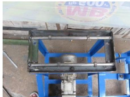
Gambar 5. Lintasan (Rel) Pisau Pemotong
