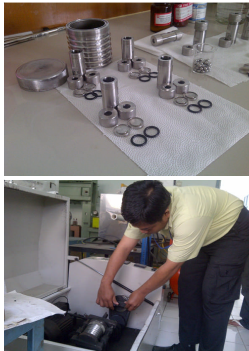
Gambar 1. Vial, bola dan fasilitas milling energi tinggi untuk proses penghalusan serbuk Fe, FeTb, FeDy dan FeCo
