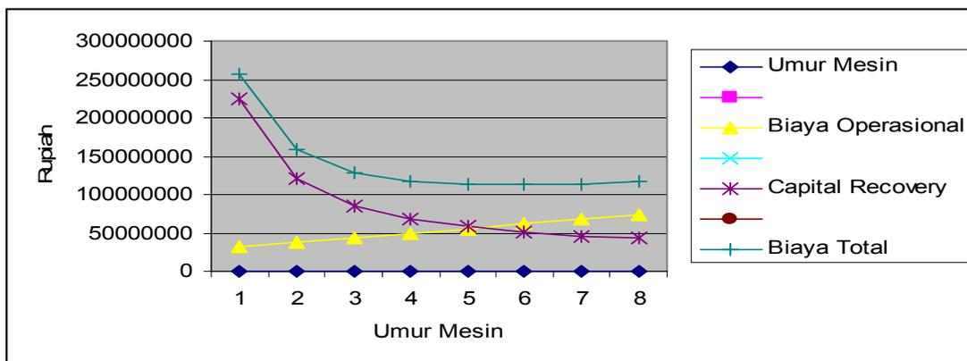
Gambar 4: Umur Ekonomis Mesin Moulding II
