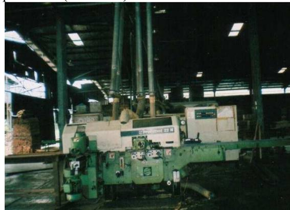
Keberhasilan PT. Andalas Lumber Product dalam memenuhi permintaan pelanggan tepat pada waktunya tidak terlepas dari peranan masing-masing mesin, salah satunya adalah mesin moulding. Mesin moulding ini berfungsi sebagai mesin penghalus dan pembentuk profile
