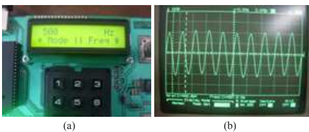
Gambar 13. (a) Frekuensi masukan 500 Hz; (b) Bentuk gelombang keluaran AD9851
