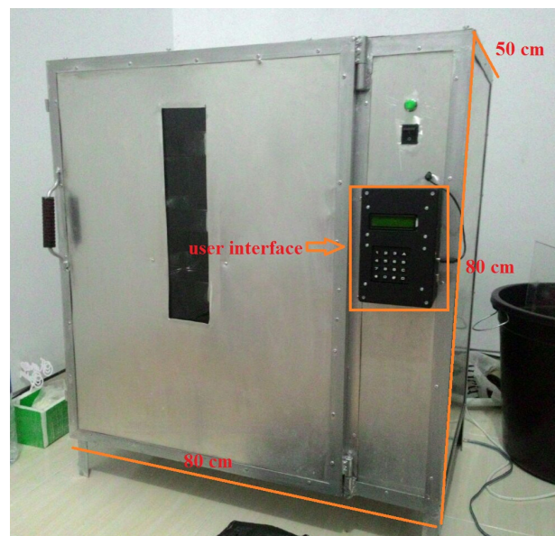
Gambar 3. Box inkubasi fermentasi dan pengeringan
