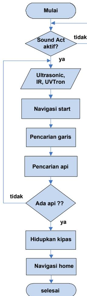
Gambar 9. Diagram Alir Sistem Keseluruhan Umum
