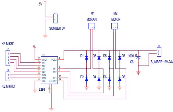
Gambar 15. Rangkaian Driver Motor DC Menggunakan IC L298 [6]
