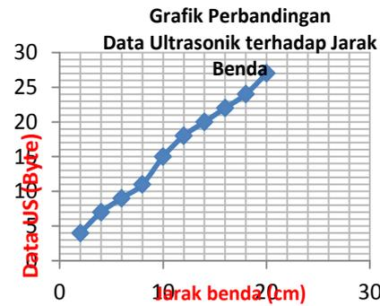
Gambar 19. Grafik Data Ultrasonic Terhadap Jarak Benda
