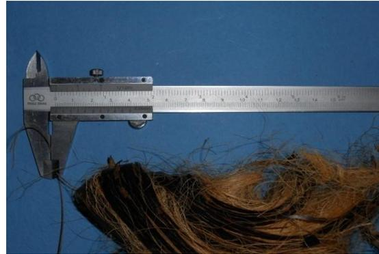
**Gambar 2.** Proses Pengukuran Serat Komposit
