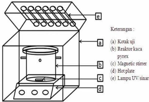
Gambar 2. Foto reaktor batch untuk uji degradasi limbah fenol
