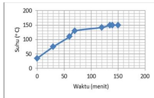
**Gambar 12** – Profil Suhu Air Dalam Boiler Terhadap Waktu
