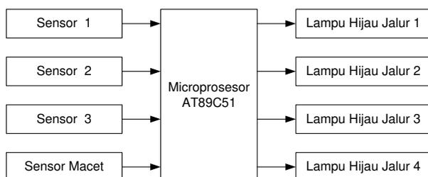
Gambar 5. Diagram blok hubungan sensor dengan lampu-lampu pengatur traffic light
