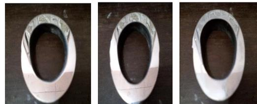
Gambar 12. Spesimen 1, 2, 3 setelah pemanasan 800°C dan sudut bengkok 180°
