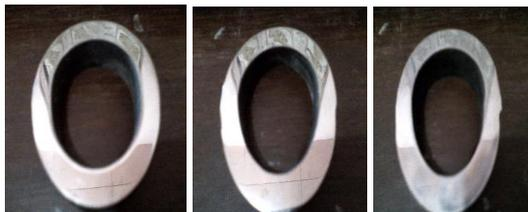
Gambar 10. Spesimen 1, 2, 3 setelah pemanasan 800°C dan sudut bengkok 90°
