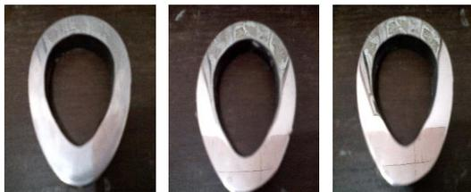
Gambar 6. Spesimen 1, 2, 3 setelah pemanasan 670°C dan sudut bengkok 90<sup>0</sup>
