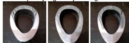
Gambar 8. Spesimen 1, 2, 3 setelah pemanasan 670°C dan sudut bengkok 180<sup>0</sup>
