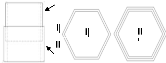
Gambar 10. Tampak atas segmen I dan II crash box berpenampang segi enam
