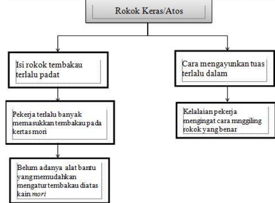
Gambar 18. RCA Defect Akibat Rokok Keras/Atos
