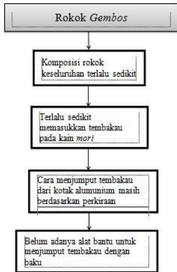
Gambar 16. RCA Defect Akibat Rokok Gembos
