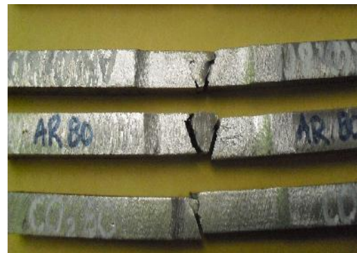
Gambar 11. Foto makro patahan uji tarik
