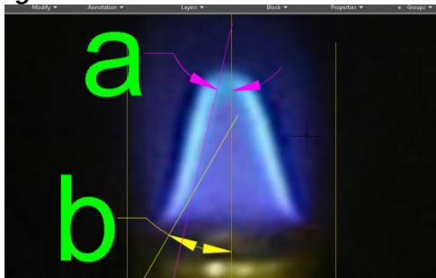
Gambar 9. Pengukuran besar sudut api
