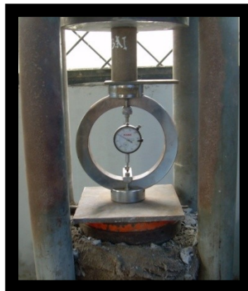
Gambar 4. Uji Tekan menggunakan alat CTM dengan Proving Ring.
