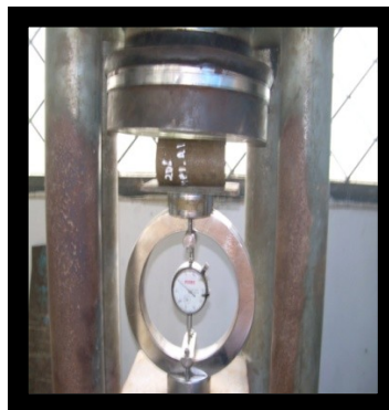
Gambar 6. Uji Tarik Belah menggunakan alat CTM dengan Proving Ring.
