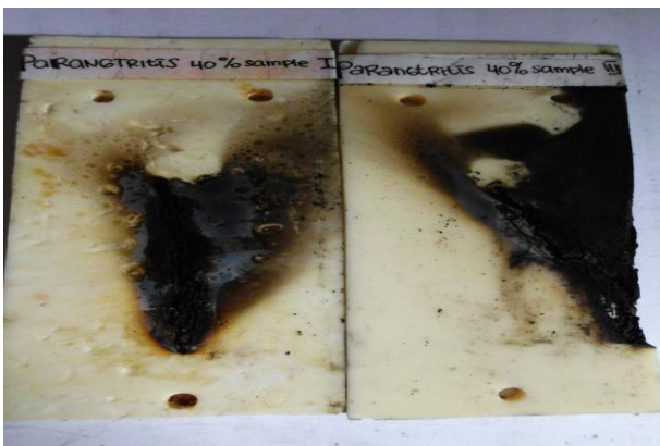
Gambar 11. Kondisi permukaan dialiri kontaminan Parangtritis
