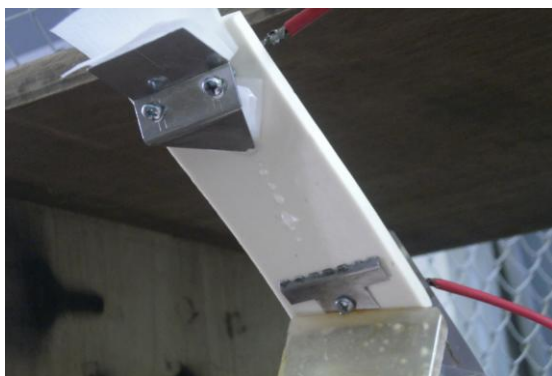
Gambar 5. Posisi elektroda, kertas saring dan sampel
