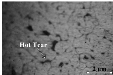
Gambar 14 : Struktur mikro titik 3 pada Als2 dengan pembesaran 400x
