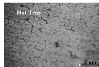
Gambar 10 : Struktur mikro titik 3 pada Als1 pembesaran 400x
